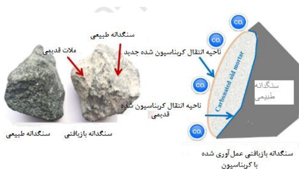
شکل (۲) - نمایش سنگدانه بازیافتی و سنگدانه بازیافتی عمل‌آوری شده با CO_2 [۱۳]
