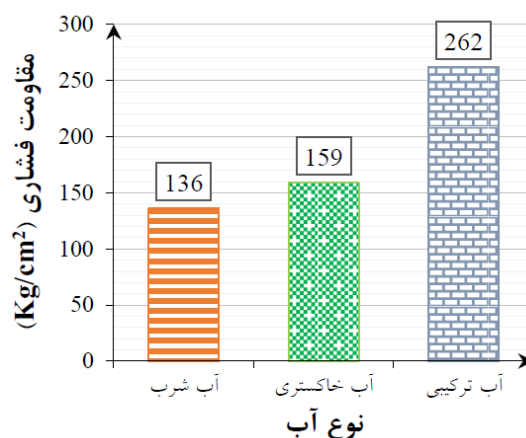
شکل ۱۱- مقاومت فشاری ۲۸ روزه بتن ساخته شده با آب شرب، خاکستری و ترکیبی [۲۱]
