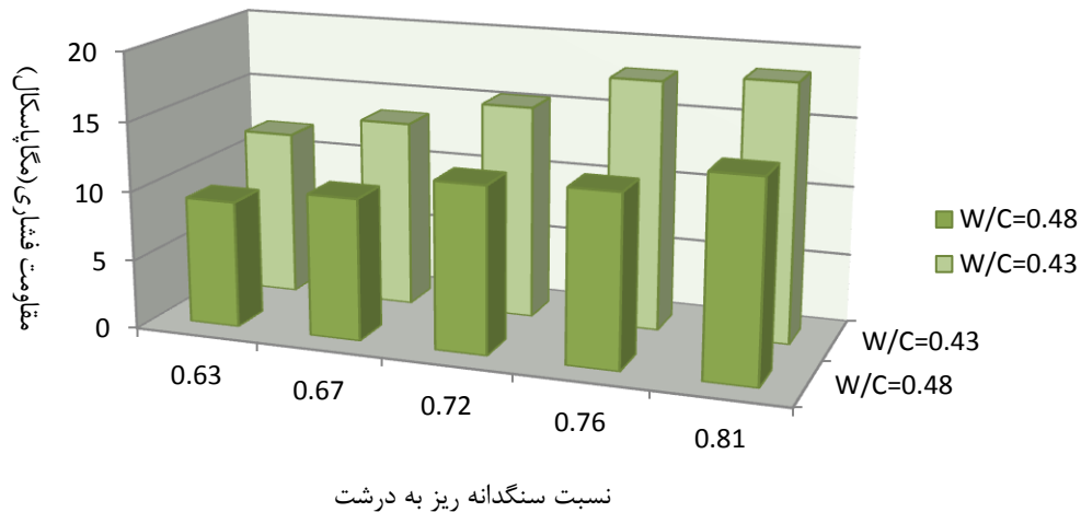
شکل ۷- تأثیر نسبت سنگدانه ریز به درشت بر مقاومت فشاری بتن برای نسبت میکروسیلیس به سیمان ۱,۷۷ درصد و برای دو نسبت مختلف آب به سیمان
