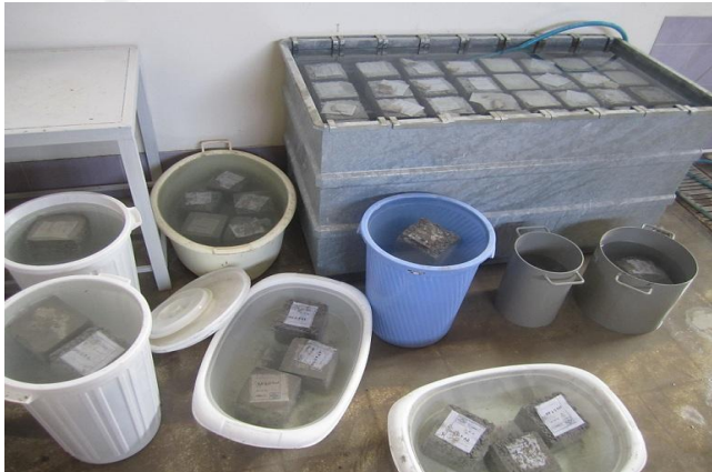
شکل ۱- نمونه های بتنی در حوضچه آب سرد
