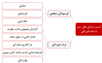
شکل ۱- دسته بندی خرابی‌های با منشأ پدیده‌های فیزیکی در بتن.
