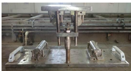
شکل ۵: دستگاه تست مقاومت خمشی تیر منشوری (بارگذاری ۴ نقطه‌ای)
