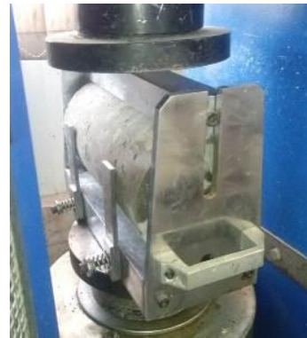
شکل ۶: دستگاه مقاومت کششی برزبلی و نحوه استقرار دستگاه و انجام آزمایش
