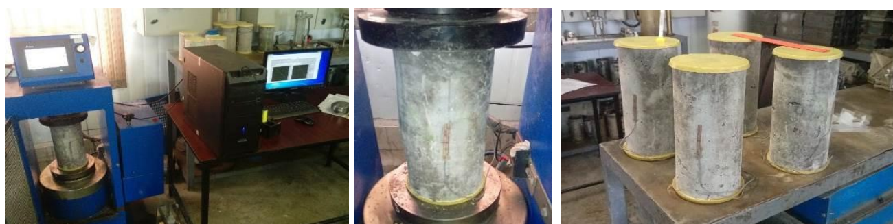
شکل ۴: کپی نگ نمونه های استوانه ای و نصب کرنش سنج های دیجیتال
