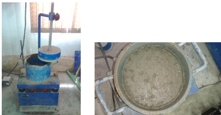
شکل ۳: دستگاه وی بی اصلاح شده و تشکیل رینگ کامل شیره ی بتن مطابق دستورالعمل اجرای آزمایش
