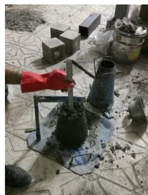
شکل ۱- اندازه گیری اسلامپ در آزمایشگاه
