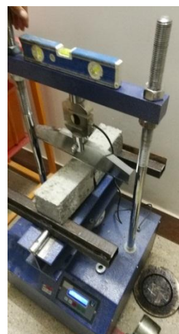
شکل ۱۰- نمونه تیر تحت بارگذاری
