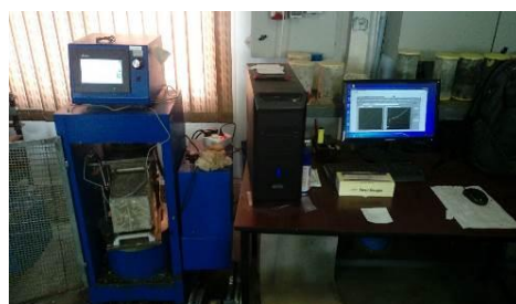
شکل ۵: دستگاه تست مقاومت خمشی تیر منشوری (بارگذاری ۴ نقطه‌ای)
