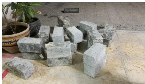
شکل ۷- نمونه های تیر پس از شکست
