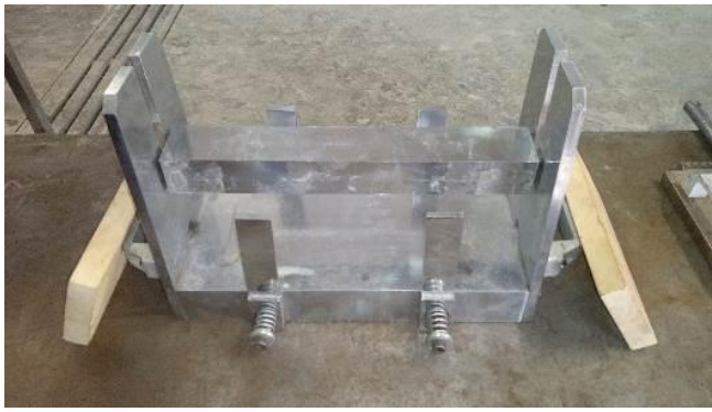
شکل ۶: دستگاه مقاومت کششی برزبلی و نحوه استقرار دستگاه و انجام آزمایش
