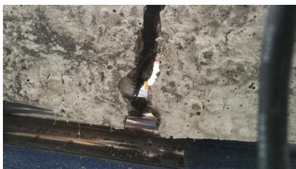
شکل ۹- نمونه های تیر در حال شکست
