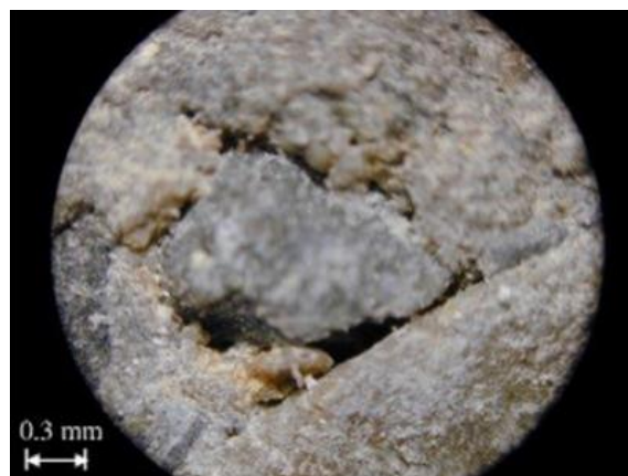
شکل ۱۰- ترک‌های اتصال بین سنگدانه و خمیر با نسبت آب به سیمان ۰/۰۵ [۷]
