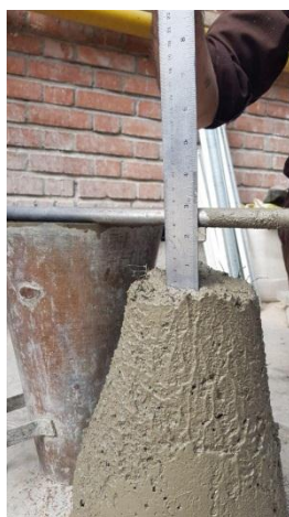
شکل ۴- اندازه گیری میزان اسلامپ بتن مطابق با استاندارد ASTM C143
