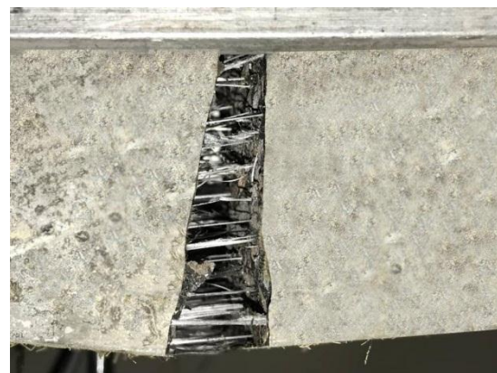
شکل ۷- تعیین عملکرد خمشی تیر های بتنی مطابق با استاندارد ASTM C1609
