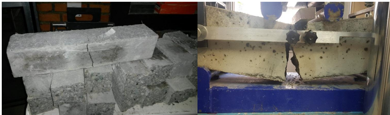
شکل ۵- تعیین مقاومت خمشی تیر های بتنی مطابق با استاندارد ASTM C78
