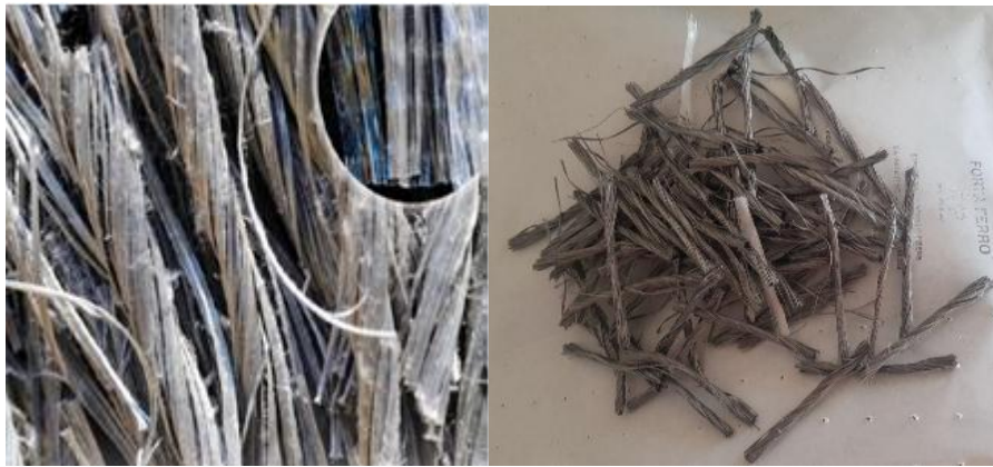
شکل ۲- الیاف ماکروسینتتیک مورد استفاده در این تحقیق
